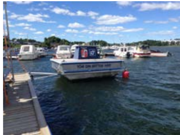
Septiktankbåten för latrintömning av fritidsbåtar.
